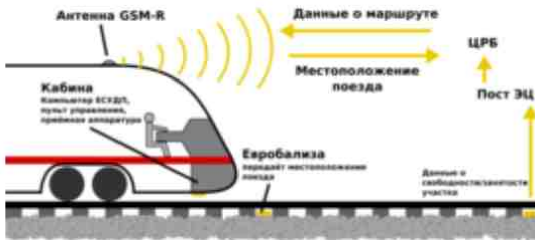
Рисунок 8 – Схема работы ETCS второго уровня
